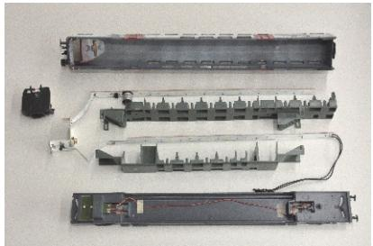
Führerstand zerlegen, Bohrung 3,5 mm für die Führerstand-Beleuchtung fertigen (Bild 2), alten Beleuchtungskörper kürzen und mit Klebepunkt fixieren (Bild 3), Führerstand von vorn im rechten Winkel auf neuen Print aufsetzen und von links einschwenken (Bild 4), Decoder an der Rückseite montieren,
